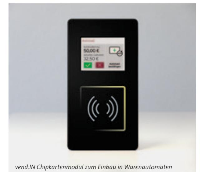
vend.IN Chipkartenmodul zum Einbau in Warenautomaten
