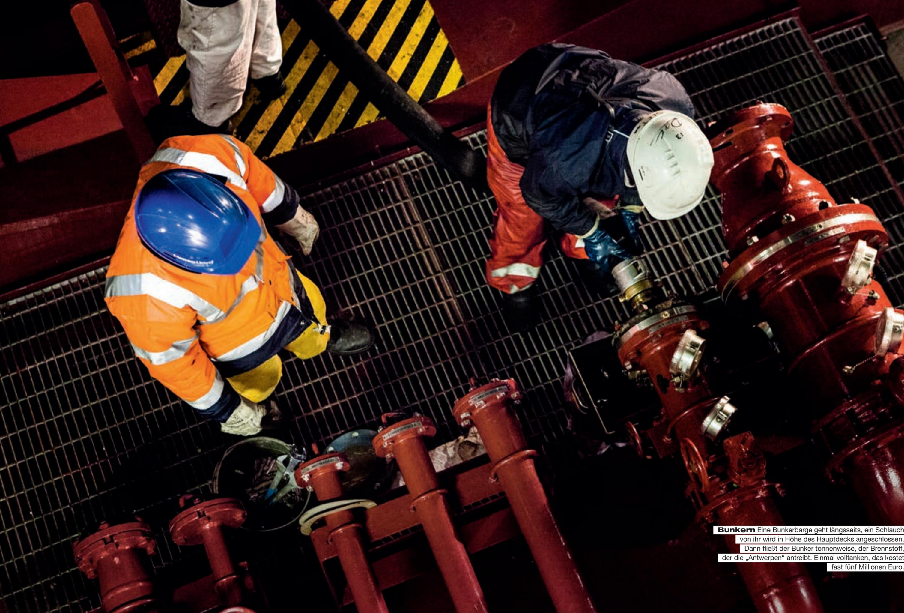
**Bunkern** Eine Bunkerbarge geht längsseits, ein Schlauch von ihr wird in Höhe des Hauptdecks angeschlossen. Dann fließt der Bunker tonnenweise, der Brennstoff, der die „Antwerpen“ antreibt. Einmal volltanken, das kostet fast fünf Millionen Euro.
